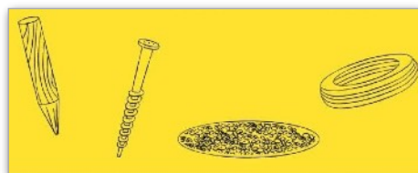
Schéma de différentes fondations extrait du guide « Habiter léger », page 10
